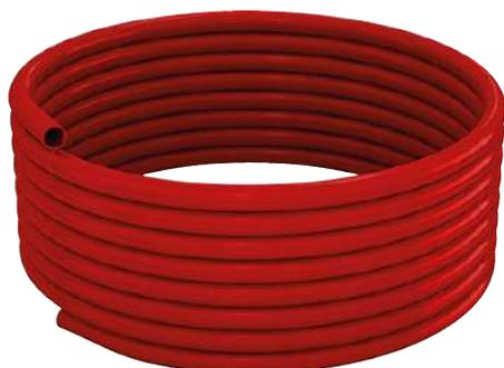
Cevi R996T-5 iz PEX-b (zamreženi polietilen, zamreženje po metodi silicijevih vodikov (silan) - stopnja zamreženja **> 65 %**) so namenjene za razvod vode v ogrevalnih in hladilnih sistemih.
