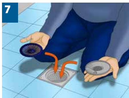
7 Ubacivanje rešetke za dlake (ili nepovratne klapne - zavisi od odabira kupca).
