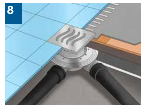
8 Postavljanje odabrane prohromske rešetke.
