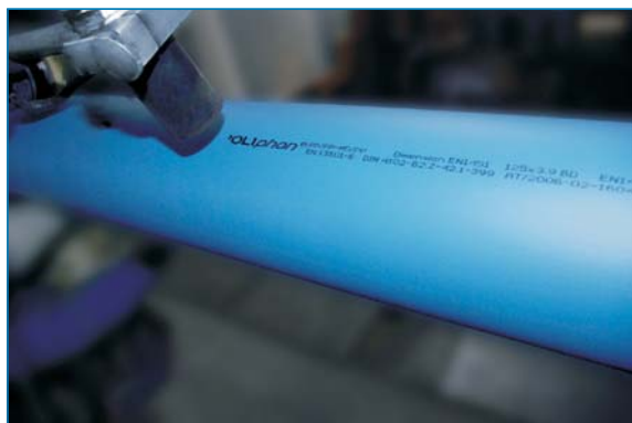
Slika 22: PØLlphon cev - proces označevanja
