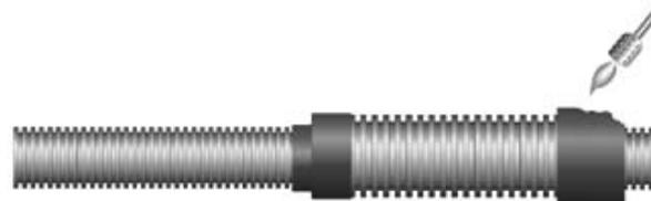
Uporabite pištolo za ogrevanje ali manjši plamen z blagim rumenim plamenom (ne uporabljajte modrega plamena) da nežno skrčite obe spojki; pol na togo spojko in pol na ovoj Microflex cevi.
