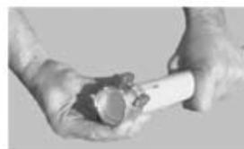
8. Potisnite zatezni obroč na cev. Pazite, da zateznega obroča ne zavrtite. Zareza v njem se bo ujela s fittingom.
