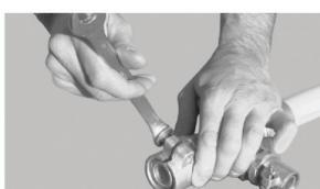
6. Vstavite kratki vijak v zatezni obroč in ga zavrtite v smeri ure proti kovancu.
