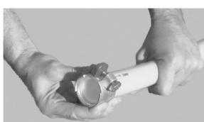
8. Potisnite zatezni obroč na cev. Pazite, da zateznega obroča ne zavrtite. Zarez v njem se bo ujela s fitingom.
